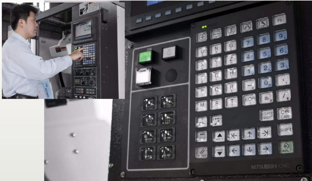
配備最現代化的高速特性控制器，三菱M70-V系統，創新的軟件功能，提高了精度，生產效率和加工過程的安全性並配備與網路接口，實現了快速直接的外部網路連接。
