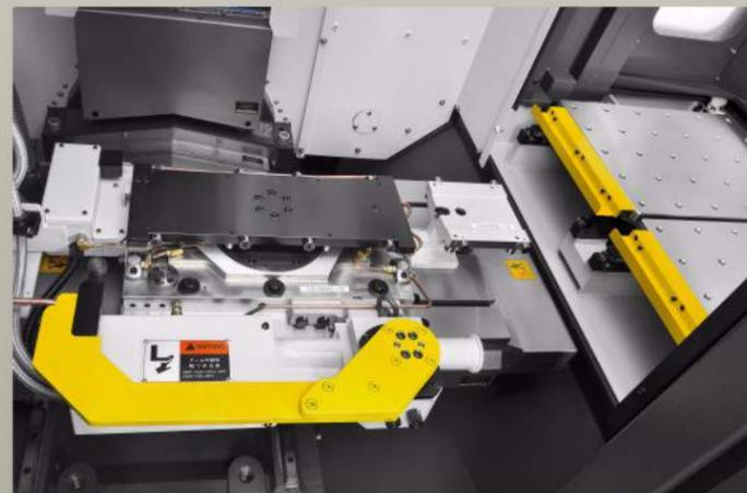
■ APC交換機構，快速、平穩、定位精度高。
