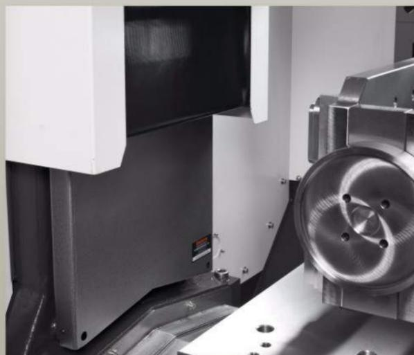
■ 獨特的Z軸防護罩設計，可有效防護Z軸傳動系統，使Z軸在快速位移平穩順暢。
