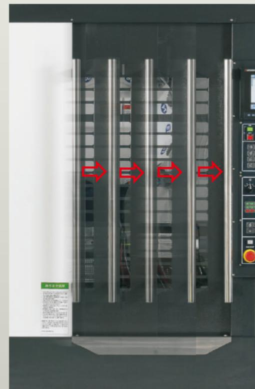
■ 自動門系統可程式 (M碼) 控制於程式終了時自動開啓門，以縮短工件裝卸時間。
