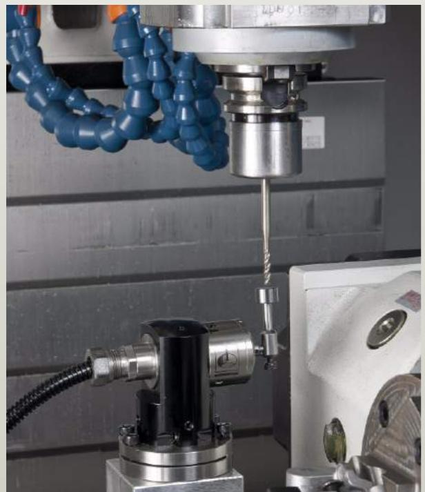
■ 自動刀具量測系統，依刀具長短值，經量測後自動輸入控制器作補償。
