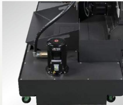
■ 高壓泵浦提供切削液系統充足壓力，以冷卻刀具與工件加工產生的熱能。
