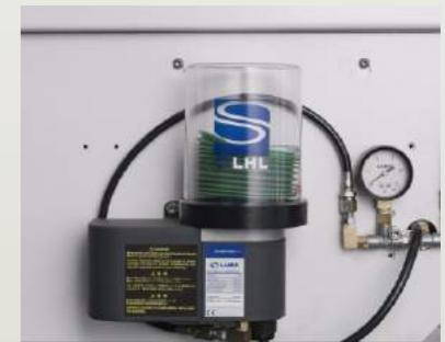
■ 選用油脂潤滑，以減少潤滑油與切削液混合，增加切削液使用壽命。
