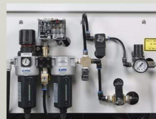
■ 空壓單元具壓力檢知，當壓力不足系統則會產生報警訊息，以確保機構正常運作。
