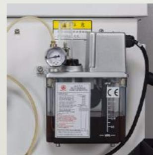
■ 採用集中潤滑系統，提供傳動系統元件潤滑，以確保精度。
