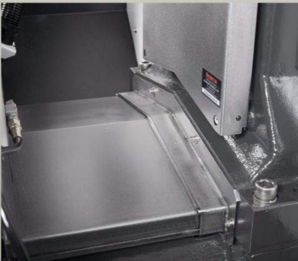
■ Y軸護罩採用全覆式，防止切屑入侵Y軸傳動系統影響精度。
