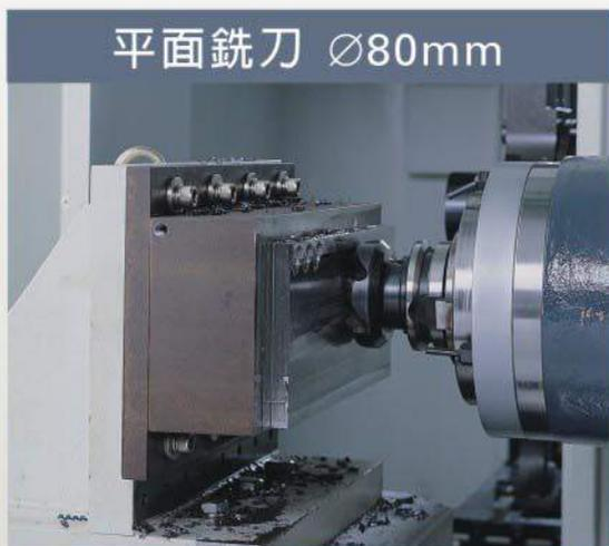
平面銑刀  $\varnothing 80\text{mm}$
