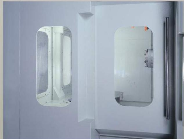
機台正面與操作門採用寬大高透視度的安全壓克力，搭配高亮度的日光燈，便於監控加工區的操作狀況。
