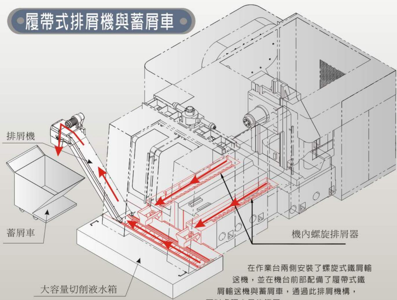
在作業台兩側安裝了螺旋式鐵屑輸送機，並在機台前部配備了履帶式鐵屑輸送機與蓄屑車，通過此排屑機構，可以處理大量的鐵屑。
