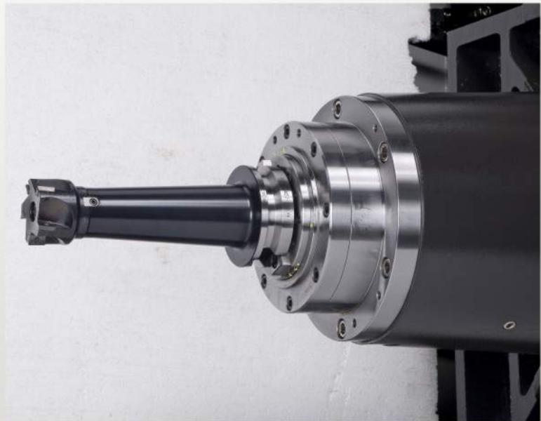
■ 主軸轉速由靜止0~6000RPM 僅需**1.7**秒
