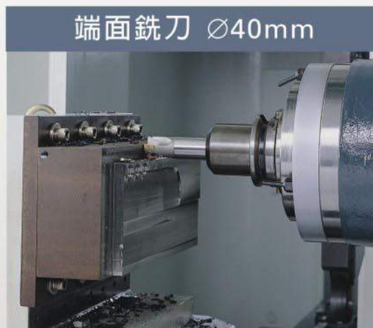
端面銑刀  $\varnothing 40\text{mm}$
