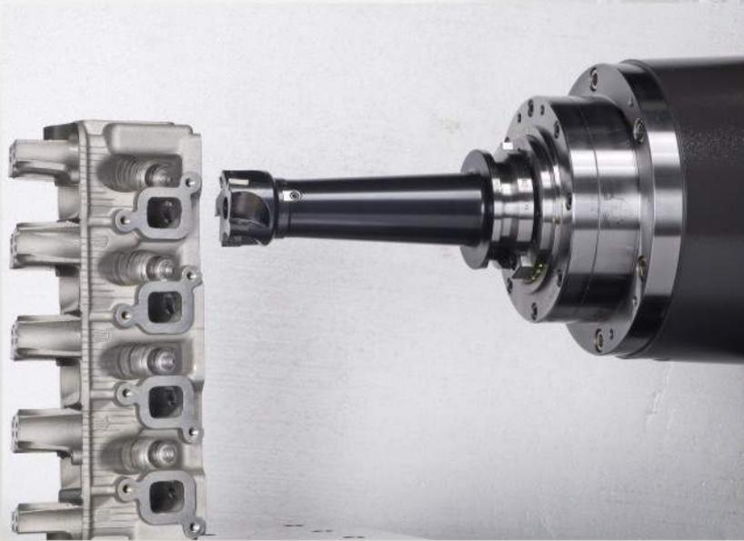
採用FANUC高性能主軸馬達，配備雙線圈，具低轉速高扭力輸出與高轉速輸出特性。
