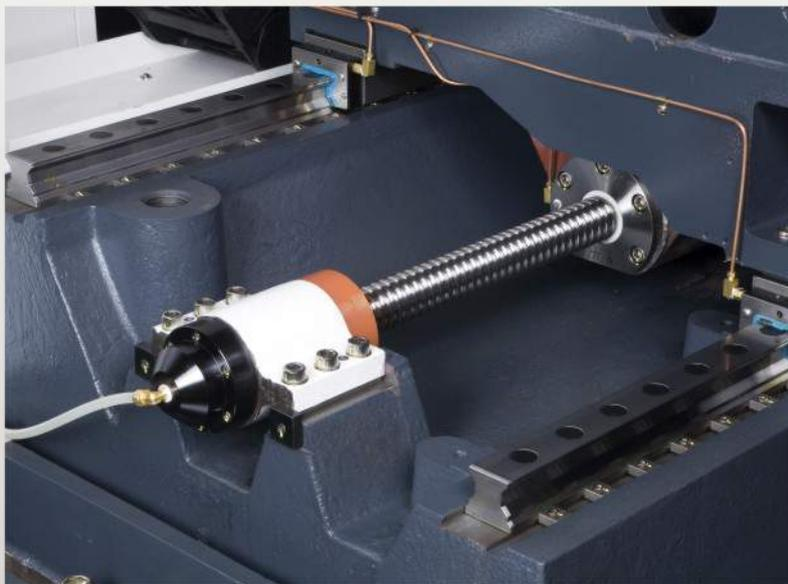
■ 三軸導桿使用大直徑滾珠導桿，增加傳動剛性，確保重覆與定位精度。
