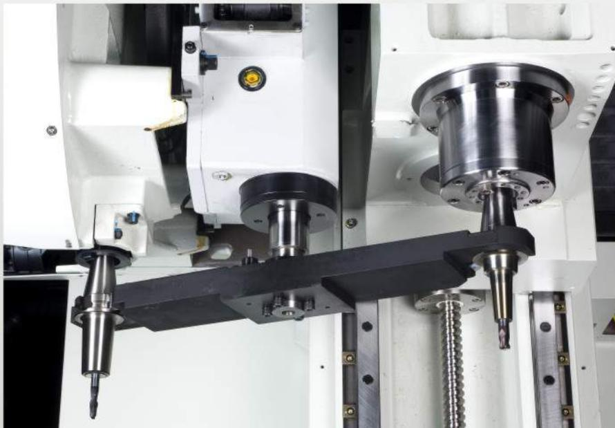
刀臂式換刀機構
