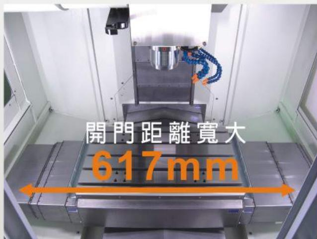
■ 超大的門寬設計，方便零件或夾治具裝卸機台。
