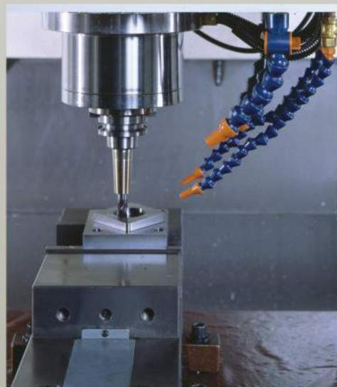
■ 在乾式切削時，使用主軸外可程式吹氣裝置，可減少切屑附著在工件的表面，影響加工表面的品質。
