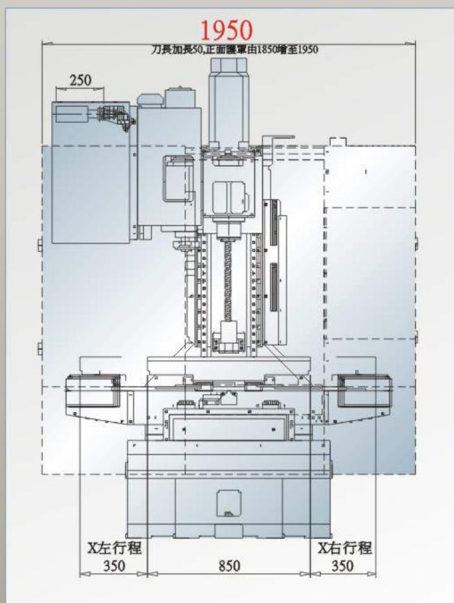
■ X軸行程可達700m/m，而機器的正面寬度為1950m/m。
