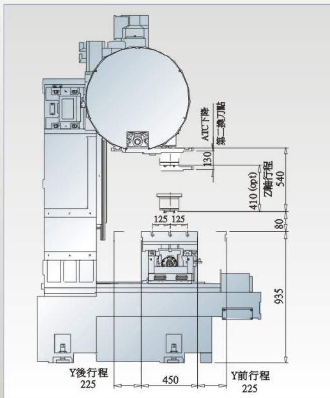
■ DV-700具有第一換刀點，加工空間為（主軸鼻端工作台面）：80m/m-540m/m，適合較高的工作加工，立柱可不用墊高，以防止降低立柱的剛性。
